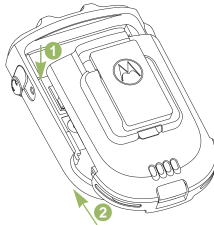
Figura 2.2: Colocación de la batería en el WRSM
